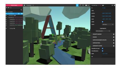
El inspector visual de A-Frame [3] es una herramienta que ofrece este framework y permite modificar una escena o los componentes que contiene. Para acceder a esta herramienta es necesario utilizar la combinación de teclas ctrl + alt + i sobre una escena A-Frame.
